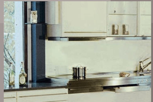
Küche im Privathaushalt mit höhenverstellbarem Koch- / Spültisch und absenkbarem Oberschrank
